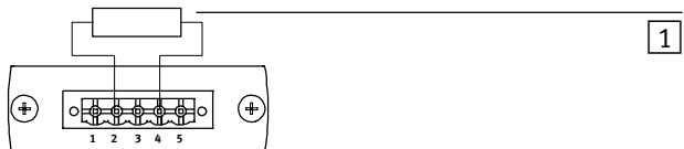
Bild 1/9: Busabschluss mit Widerstand am Open Style Anschluss
