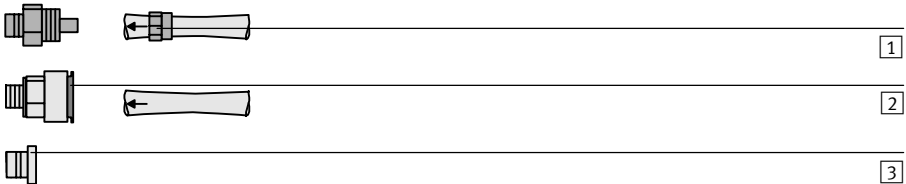
Fig. 3.3 Montieren der Verschlauchung
