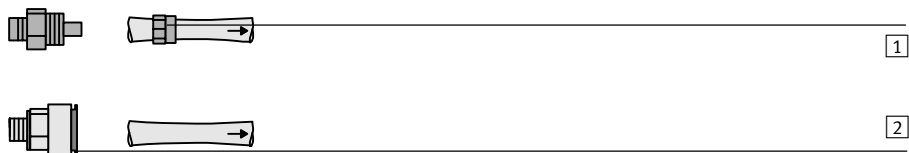
Fig. 3.4 Demontieren der Verschlauchung
